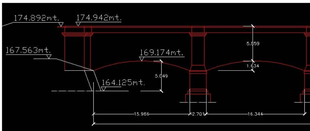
Figura 20 – Caratteristiche geometriche dell'attraversamento del canale Cavour (dettaglio).
