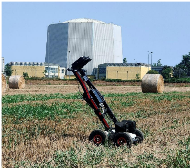
Figura 5 – Strumentazione georadar IDS RIS Hi-Mod (IDS, Italia)
