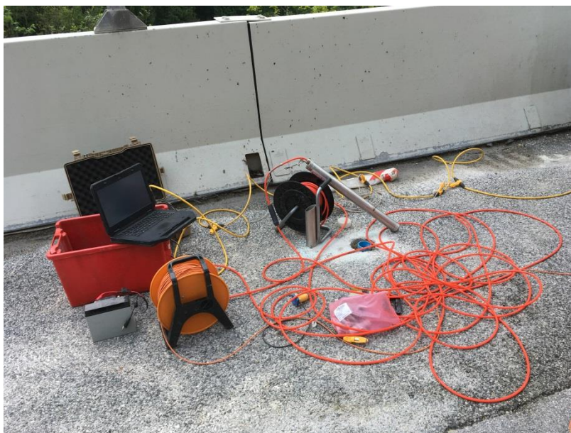
Figura 1 – Strumentazione utilizzata per misure in foro di tipo downhole
