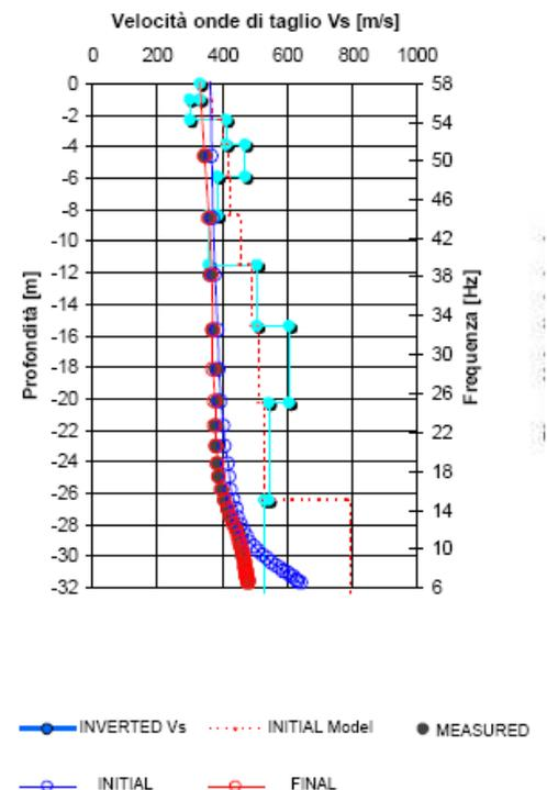
Figura 2 - Modello di propagazione delle velocità delle onde Vs
