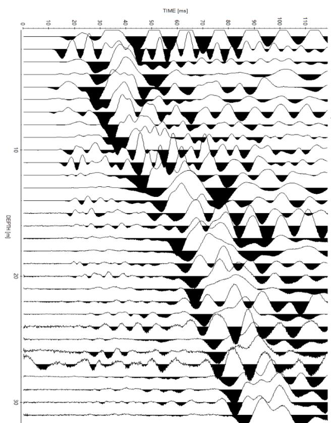
**PROFILO DI VELOCITA' DELLE ONDE DI COMPRESSIONE E DI TAGLIO**
