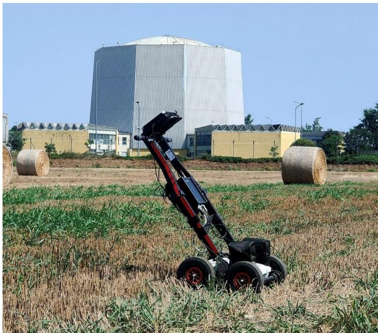
Figura 5 – Strumentazione georadar IDS RIS Hi-Mod (IDS, Italia)
